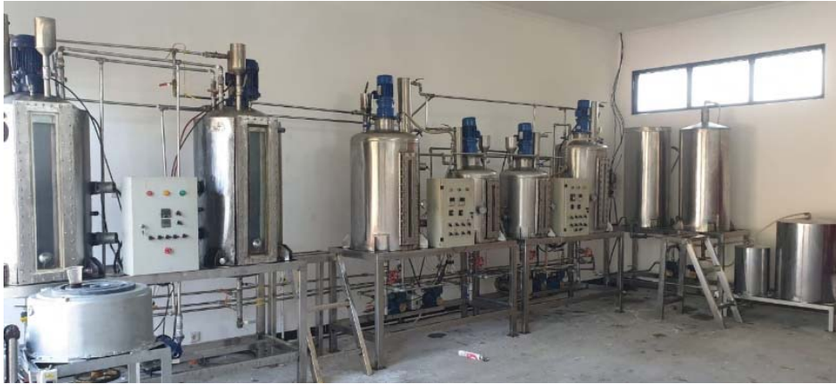
Gambar 50. Reaktor biodiesel yang sudah dilengkapi dry oil reaktor dan filtering biodiesel kapasitas 900 liter bahan baku (1.600 liter biodiesel/10 jam)
